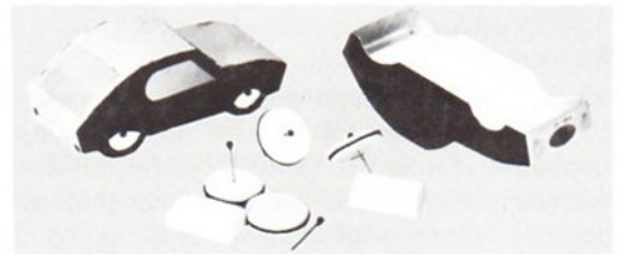
Abb. 9 Sportwagen: Aufbauten aus Karton, Bodenplatte und Achslager aus Styropor, Räder aus Gips, Reifen aus Gummi, Stecknadeln als Achsen.
